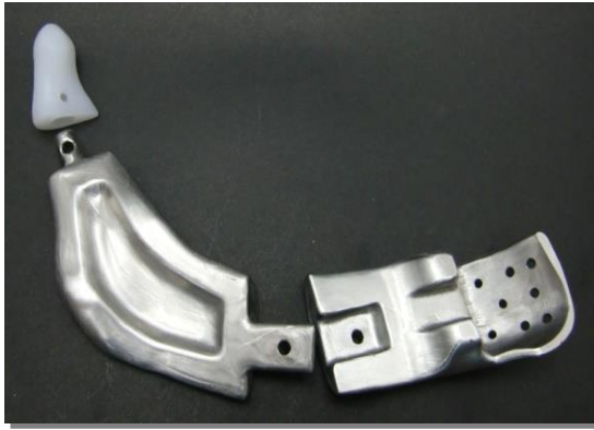
วัสดุฝังในเฉพาะบุคคลชนิด Net Shape Titanium ในตำแหน่งครึ่งหนึ่งของขากรรไกรล่างซ้าย
